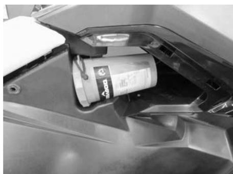
已拆下右侧板件
