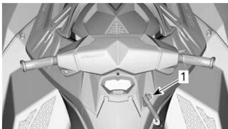
若要让发动机起动，则必须牢固地将紧急熄火拉绳安装到发动机熄火开关上。
